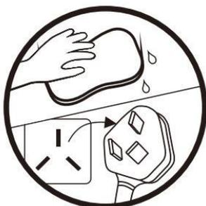
Перед чисткой осушителя следует обязательно выключить прибор и обесточить. Вентилятор вращается с высокой скоростью и может привести к травме. Обесточивание может предотвратить поражение электрическим током.
