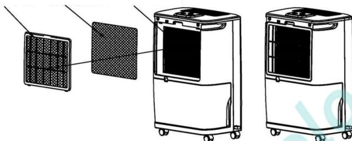
**Примечания:** Очищайте поверхность фильтра два раза в месяц, чтобы обеспечить здоровую окружающую среду и энергосбережение.
