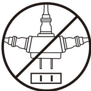
Запрещается заменять шнур питания или подключать кабель питания через переходники параллельно. Несанкционированная замена, промежуточное соединение, перегрузка могут привести к поражению электрическим током или пожару. Если шнур питания поврежден, обратитесь к местному дилеру или в сервисную сеть для ремонта. Несанкционированная разборка, модификация, ремонт или чистка внутренних компонентов запрещены.
