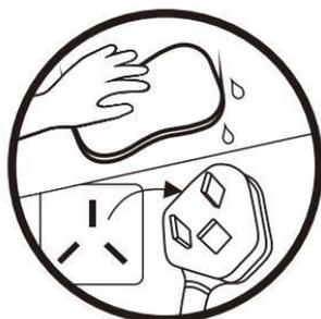
Перед чисткой осушителя следует обязательно выключите прибор и обесточить. Вентилятор вращается с высокой скоростью и может привести к травме. Обесточивание может предотвратить поражение электрическим током.
