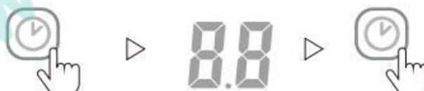
Нажмите кнопку «Таймер», индикатор синхронизации загорится зеленым, для установки необходимого времени работы в пределах 1-24 часа, а затем нажимайте кнопку «Таймер» до тех пор, пока на дисплее не появится 00. После восьми сек на дисплее отобразится текущая влажность и функция синхронизации будет отключена. По истечении заданного времени компрессор остановится автоматически.
