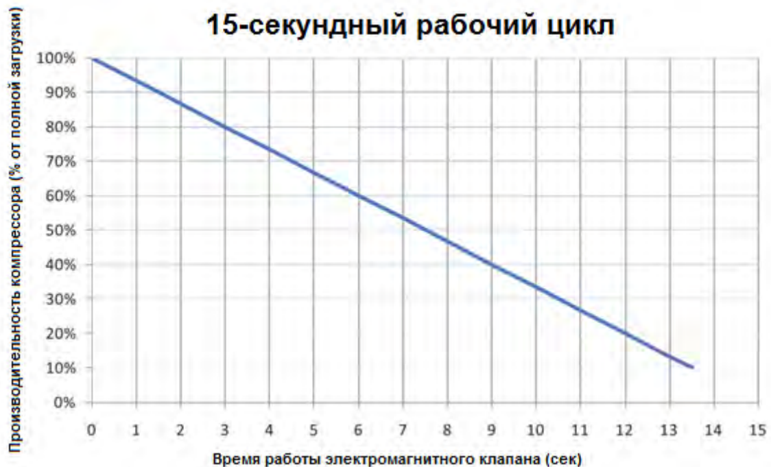
Рис 6: Время открытия электромагнитного клапана в 15-секундном цикле в зависимости от нагрузки
