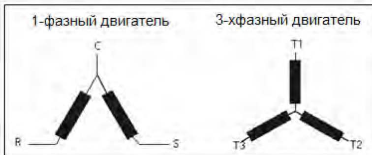
Рис 31: Схемы электродвигателей ZRD/ZPD
