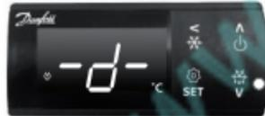
DEFROST (ОТТАИВАНИЕ): нажмите на 3 секунды для прекращения ручного оттаивания. Во время оттаивания отображается значок DEFROST (ОТТАИВАНИЕ).
