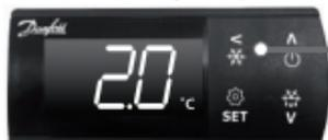
**PULL DOWN (ЗАХОЛАЖИВАНИЕ):** нажмите на 3 секунды для инициирования захлаживания.
