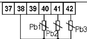
**Ратиометрические датчики (0.5÷4.5В пост. тока)****Всасывание 1 (P1C = 0-5)**
