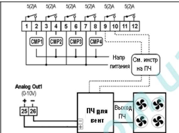
**Установка с 1-м компрессором с ПЧ + 2 стандартных компрессора и 3 вентилятора:**
