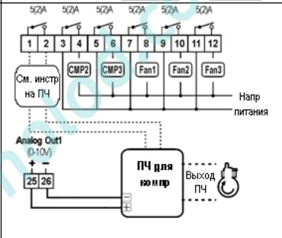
**Установка с 3-мя компрессорами в 1-м контуре, 3-мя компрессорами во 2-м контуре, и ПЧ для вентиляторов:**
