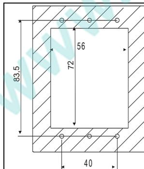
Выносная клавиатура **VC660** устанавливается в вертикальной панели, в проем 72x56мм, и фиксируется винтами  $\varnothing$  3 x 2мм. Для получения класса защиты лицевой панели IP65 используйте резиновую прокладку (мод. RGW-V).
