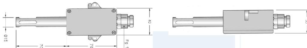
**NTC датчики для установки на стену (-40...120°C)**
