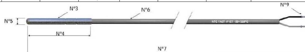
**NTC датчики с двухслойным TPE кабелем и стальной головкой, быстрый отклик (-50...+110°C) - ОСНОВНАЯ ГРУППА**
