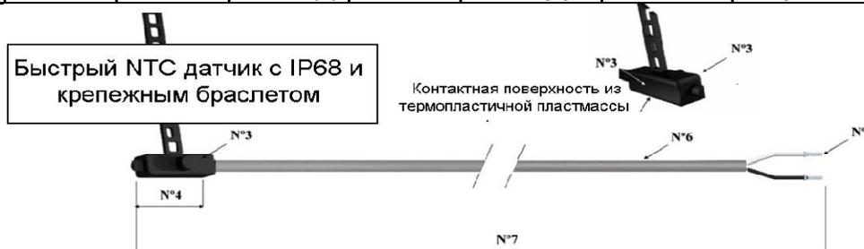
**NTC датчики с двухслойным TPE кабелем и пластиковой головкой с крепежным браслетом (-50...+110°C) - ОСНОВНАЯ ГРУППА**
