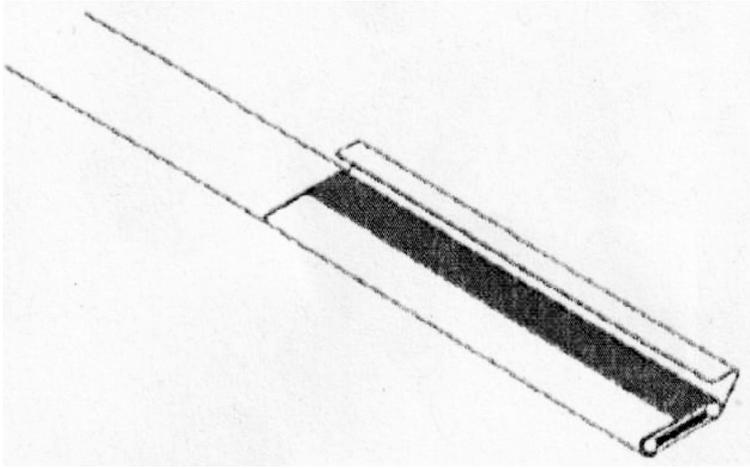
2. Сделать продольный разрез по центру кабеля между первым поперечным разрезом и его краем.
