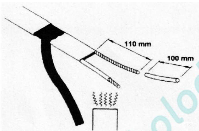
9. Надеть термоусадочную трубку на каждый провод и разогреть термофеном до полной ее усадки.
