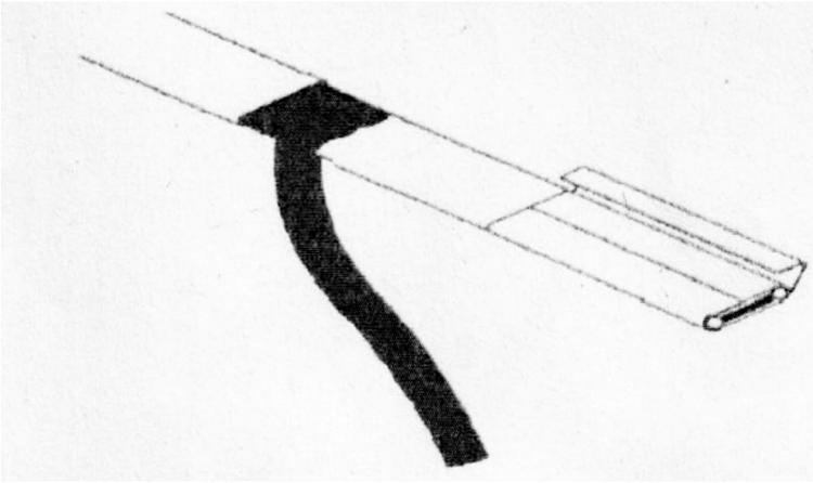
5. Снять верхнюю изоляцию с нагревательной ленты.
