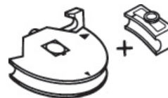
Compuesto de hormas de aluminio forjado y el patín de curvado correspondiente. Comprising forged aluminium formers and the applicable bending hoe.
