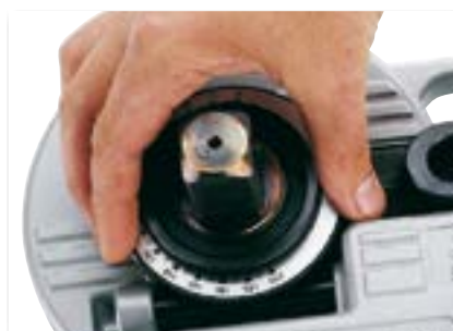
Ручная настройка угла гибки от 0 до 180°
