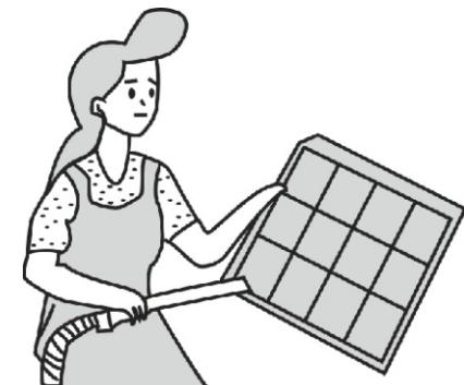
1. Відкрийте зовнішню панель, візьміться за ярлик повітряного фільтру і, дещо піднявши його, витягніть фільтр.
