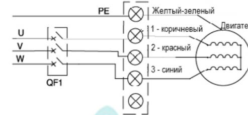
5. Схема проводки для обычного однофазного двигателя
