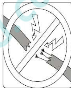
Перевірити цілісність кабелів
